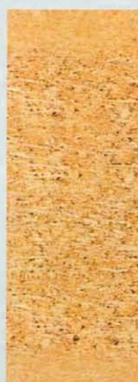
Strohfaserplatte, in Dicken von 12 bis 125 mm erhältlich (Stropoly)
