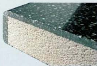
Blähglas als Trägerwerkstoff der Compactplatten (Schock)
