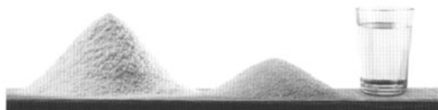
Les ingrédients du SLP: sciure, levure et de l'eau
